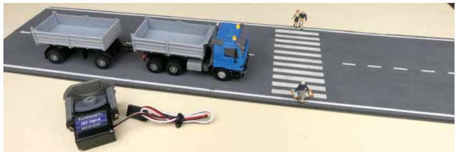
Unter Stoppstellen – wie z. B. an diesem Fußgängerüberweg – werden Servomagnete installiert
