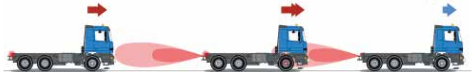
Die CarMotion-Kraftfahrzeuge besitzen an den Stirnseiten Infrarotsender und -empfänger, die eine sichere Abstandsregelung beim Fahren gewährleisten
