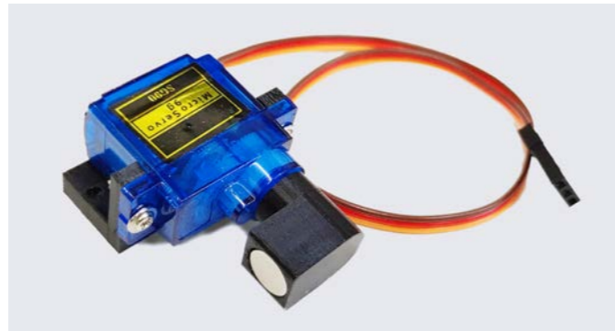
Die fertig montierte Servo-Stoppstelle.
